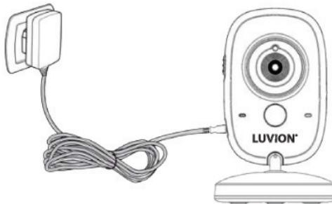
4. Gebruik de aan/uit schakelaar om de camera aan te zetten. De Power-LED zal oplichten zodra de camera werkt.
