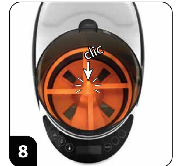
Posez maintenant la **roue à mélanger** sur l'axe et appuyez fermement jusqu'à ce que les pièces se fixent avec un **déclic**. Tirez sur la roue à mélanger pour vérifier la solidité de l'installation; la roue ne devrait pas se soulever facilement.
